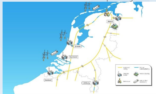
Waterstofbackbone Gasunie. Deze backbone brengt vraag en aanbod bij elkaar en bestaat grotendeels uit bestaande leidingen (Zie voor meer details bron 21, bijlage 5).
